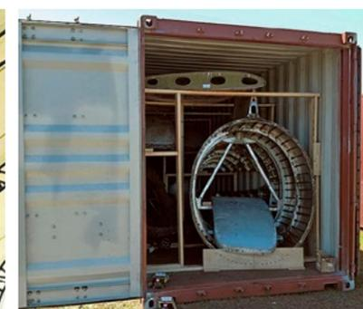
Die vielen Einzelteile, die für den Transport demontiert wurden, wurden sorgfältig in extra dafür gebaute Gestelle in verschiedene Container verladen.
